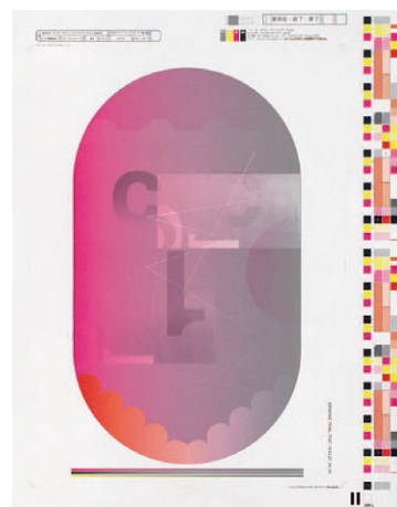
銀とマゼンタのグラデーションが左右から交差する仕組み。あごの「ひげ」の部分にのみイエローが入っている
