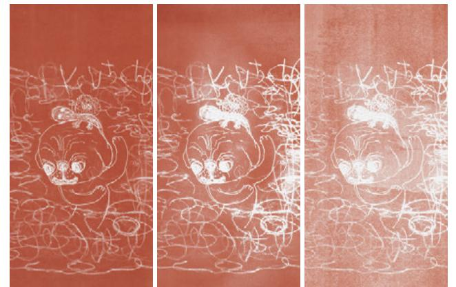
左より、通常通りの印刷、①焼きボケをつくった印刷、②さらに水負けを起こした印刷
