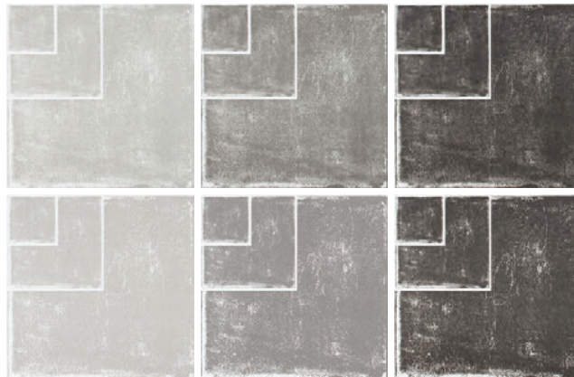
原稿の摺り（上左より、薄摺り、中摺り、下左より、濃摺り、模様） ノーマル製版、濃度100%の刷り上がり。矩形一つで拡大率100%、200%、400%を確認できる
