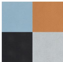
◀ 網点の形は正三角形、網点の角度の差は1度。線数は上部が18線、下部が72線
