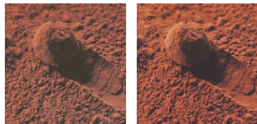
◀ “隠し味”はインキへのマットニス混入、“仕上げ”はマットニスのノイズ版。左がマットニス混入率70%、右が0%
