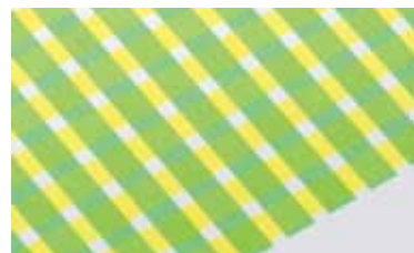
実験① 白い紙に刷る 不透明とされる蛍光インキだが、刷ってみると予想外に下の柄を透過して単なるチェック柄に見えてしまった。
