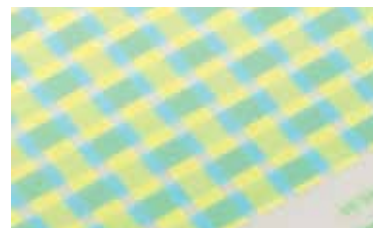
実験② 透ける紙（用紙：NTパイル）に刷る 表裏印刷で織りの構造を再現。インキの調整で上下感を強調したが、目指した質感にはならなかった。
