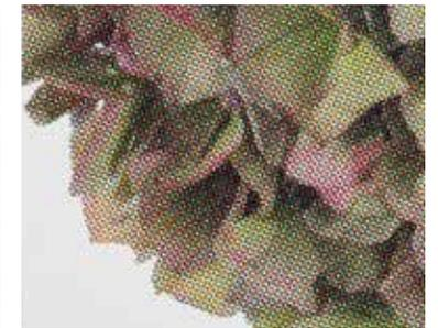
結果：1線相当の網点の間隔は約2.5cmとなり、2線での間隔は半分の約1.25cm、また、網点の面積は4分の1になる。1線では遠くでも近くでもほとんど像の形を認識できないが、2線を越えるとはっきりした絵柄ならある程度視認できるようになってくる。結論として、再現する画像の色みやコントラストによって、「見える、見えない」の境が異なることが確認できた。
