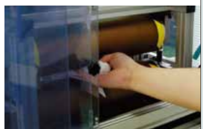
ローラー巻き込まれ体感 回転している2つのローラーに引きずり込まれるように手が巻き込まれることを体感
