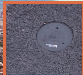
スマートパーキング 駐車場の空き状況を小電力無線のセンサ・Wi-Fi経由で提供。駐車場収容の増加・渋滞緩和、観光客の滞在時間増加につながる
