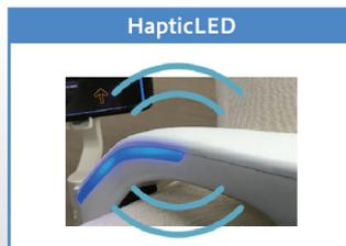
遠隔指示を振動と発光により伝達装着者は騒音下での指示判別、周辺への注意喚起。
